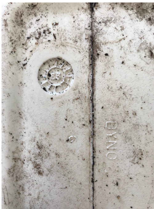
Figur 5 Bildet viser bunnen av en kjemikaliebeholder fra 1983. Beholderen har markert inn 6 prikker i «årshjulet», noe som viser at den ble produsert i juni måned (Foto: SALT).
